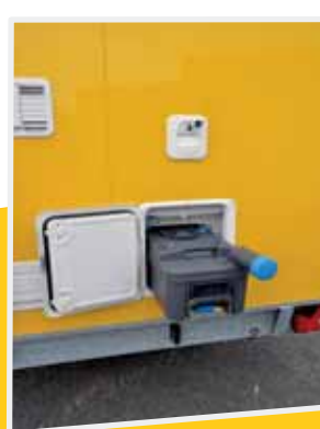
Réservoir à matières
