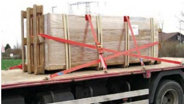
Sangle d'arrimage standard avec cliquet de traction robuste et anticorrosion et crochet étroit.
